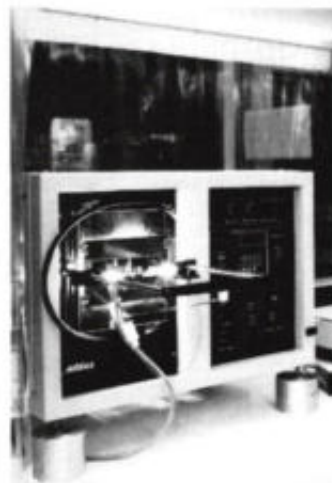
Afb. 4. Het snelle annealingsysteem dat AET in samenwerking met het CNET heeft ontwikkeld en dat nu produktieklaar is. Hier afgebeeld staat het apparaat dat geschikt is voor laboratoriumonderzoek. Er is ook een automatische versie leverbaar.
